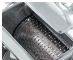
Valjak od nehrdajućeg čelika
